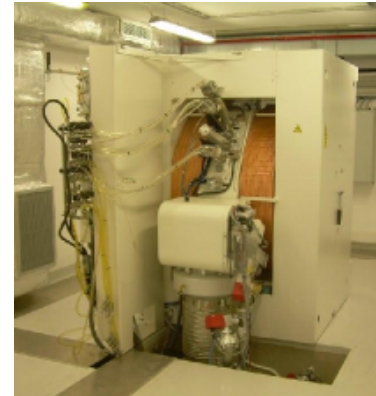
PETtrace protony 16,5 MeV wiązka zewnętrzna 25 \mu\text{A} Środowiskowe Laboratorium Ciężkich Jonów
