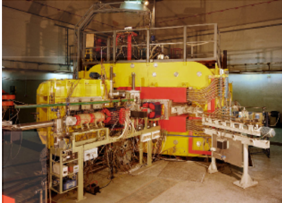
U-200P cząstki \alpha 32 MeV wiązka wewn. \sim 1 \mu\text{A} ŚLCJ
