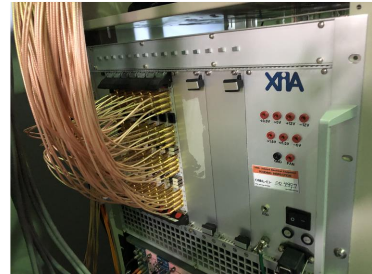
Cyfrowe zbieranie danych (UTK/ORNL) obsługujące eksperyment Z=119 w RIKEN. Nowe moduły 16-bit Pixie z ORNL w 2020
